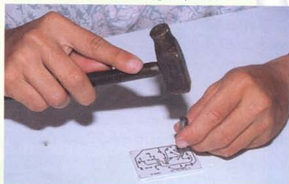
Figura 5.23. Marcando los puntos sobre la plaqueta
